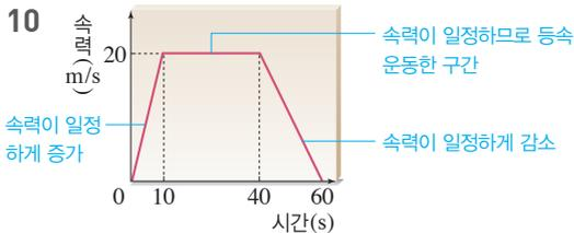
등속 운동을 한 구간은 10~40초이므로, 이동한 거리는  $20 \text{ m/s} \times (40 - 10) \text{ s} = 600 \text{ m}$ 이다.
