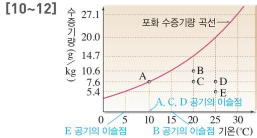
10 D 공기의 상대 습도(%) =  $\frac{\text{실제 수증기량}}{\text{포화 수증기량}} \times 100 = \frac{7.6 \text{ g/kg}}{20.0 \text{ g/kg}} \times 100 = 38\%$
