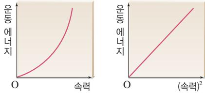
18 정지해 있던 물체에  $20\text{ N} \times 10\text{ m} = 200\text{ J}$ 의 일을 해주었으므로,  $10\text{ m}$  이동한 순간 물체의 운동 에너지는  $200\text{ J}$ 이 된다. 따라서  $\frac{1}{2} \times 4\text{ kg} \times v^2 = 200\text{ J}$ 에서 물체의 속력  $v = 10\text{ m/s}$ 이다.
