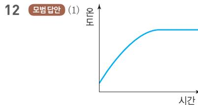
(2) 처음에는 알루미늄 컵이 흡수하는 복사 에너지양이 방출하는 복사 에너지양보다 많아서 온도가 상승하고, 일정한 시간이 지나면 알루미늄 컵이 흡수하는 복사 에너지양과 방출하는 복사 에너지양이 같아져 복사 평형에 도달하여 온도가 일정해진다.
