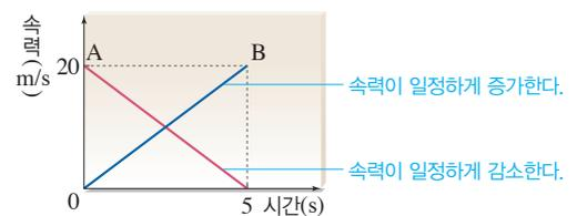
ㄴ. A가 5초 동안 이동한 거리는  $\frac{1}{2} \times 20 \text{ m/s} \times 5 \text{ s} = 50 \text{ m}$  이므로 평균 속력은 10 m/s이다. B가 5초 동안 이동한 거리도  $\frac{1}{2} \times 20 \text{ m/s} \times 5 \text{ s} = 50 \text{ m}$  이므로 평균 속력은 A와 같다.
