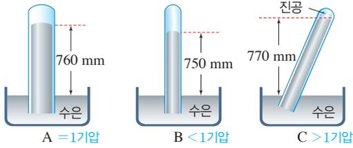
1기압은 수은 기둥 760 mm(76 cm) 높이에 해당하고, 기압이 높은 곳일수록 수은 기둥의 높이가 높다. 유리관의 굵기나 기울기로 인해 수은 기둥의 높이가 달라지지 않으므로, A는 1기압이고, B는 1기압보다 작으며, C는 1기압보다 크다. 따라서 기압의 크기는  $C > A > B$ 이다.
